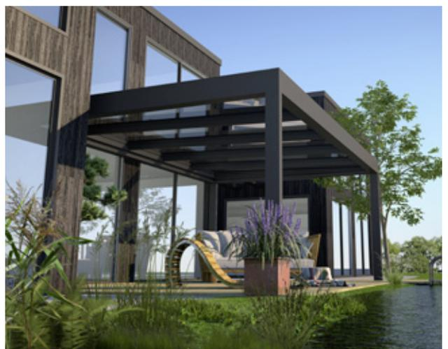
Ausgeführt wird der Fronträger als einteilige Konstruktion. Die Rinne wird in den Fronträger eingehängt und führt in den Seitenträger. Die Entwässerung erfolgt verdeckt über den Pfosten.
